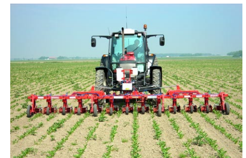
Aardappelopslagbestrijding met strokenstrijkers.
